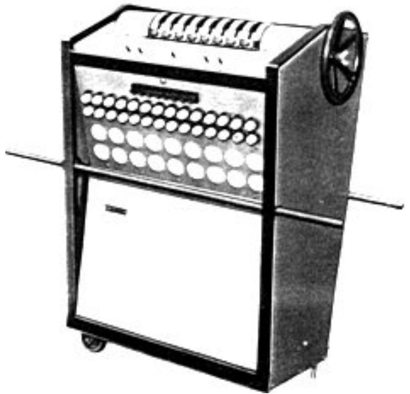
Bilder 24 und 25: Zwei transportable Stellwerke mit eingebauten Schaltern, Sicherungen und Ringkernreglern.
