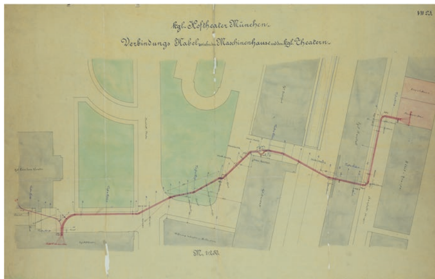
Fig. 1.5 “Connecting cable between the Maschinenhaus and the royal theaters,” Königliches Hoftheater München. (Theaterwissenschaftliche Sammlung, University of Cologne)
