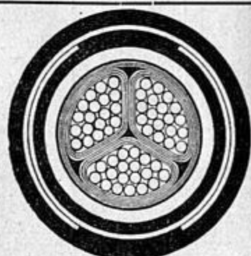
Dreifachkabel K 1170 Leiter sektorförmig NSPDVR 750
