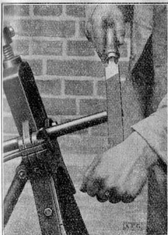
Abb. 59. K 1237 Brechen der Rohrkante.
