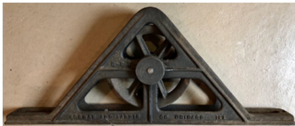
Fig. 8 Loft Block manufactured/hergestellt by/von Sosman & Landis, ca. 1920.
