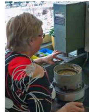
Handarbeit nötig: Vormontieren der Irisblenden mit viel Fingerspitzengefühl
